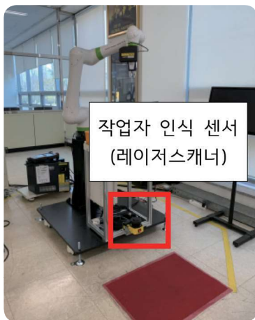
협동로봇 협동운전영역 바닥 표시
